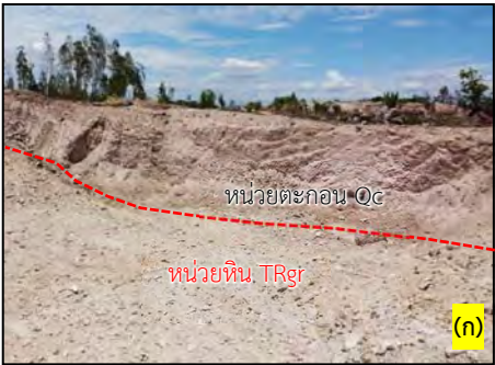
หน่วยตะกอน Qc เป็นตะกอนหินกรวดมน สีผิวผูลี้น้ำตาลดำ ลักษณะผุคล้ายหินศิลาแลง (laterite) สีผิวสด สีนํ้าตาลแดง เนื้อหินลักษณะเป็นเนื้อเม็ด มีเม็ดตะกอนขนาด granule ถึง pebble บริเวณขอบพื้นที่คำขอ ประทานบัตรทางทิศตะวันออกเฉียงใต้
