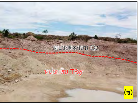
หน่วยตะกอน Qc เป็นตะกอนหินกรวดมน สีผิวผูลี้น้ำตาลดำ ลักษณะผุคล้ายหินศิลาแลง (laterite) สีผิวสด สีนํ้าตาลแดง เนื้อหินลักษณะเป็นเนื้อเม็ด มีเม็ดตะกอนขนาด granule ถึง pebble บริเวณขอบพื้นที่คำขอ ประทานบัตรทางทิศตะวันออกเฉียงใต้
