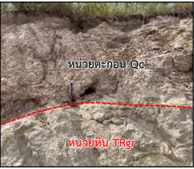
แสดงรอยต่อ (Contact) ระหว่างหน่วยตะกอน Qc และเนื้อหินแกรนิต TRgr บริเวณผนังบ่อตอนกลางของพื้นที่คำขอประทานบัตร และลักษณะเนื้อหินที่นำไปใช้สำหรับ หินแกรนิตเพื่ออุตสาหกรรมเซรามิก ภาพถ่าย ตำแหน่งพิกัด 629622E 1690090N มองไปทางทิศตะวันตก
