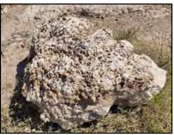
ชั้นตะกอน Qc ลักษณะเป็นตะกอนกรวดปนทรายและศิลาแลง (laterite) ที่มีสารเชื่อมประสาน เป็นซิลิกา พบทางทิศตะวันออกเฉียงใต้ของพื้นที่คำขอประทานบัตร
