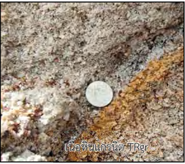
แสดงรอยต่อ (Contact) ระหว่างหน่วยตะกอน Qc และเนื้อหินแกรนิต TRgr บริเวณผนังบ่อตอนกลางของพื้นที่คำขอประทานบัตร และลักษณะเนื้อหินที่นำไปใช้สำหรับ หินแกรนิตเพื่ออุตสาหกรรมเซรามิก ภาพถ่าย ตำแหน่งพิกัด 629622E 1690090N มองไปทางทิศตะวันตก
