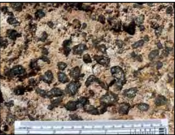
ชั้นตะกอน Qc ลักษณะเป็นตะกอนกรวดปนทรายและศิลาแลง (laterite) ที่มีสารเชื่อมประสาน เป็นซิลิกา พบทางทิศตะวันออกเฉียงใต้ของพื้นที่คำขอประทานบัตร
