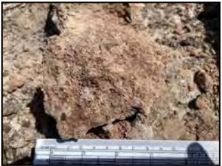
หน่วยตะกอน Qc เป็นตะกอนหินกรวดมน สีผิวผูลี้น้ำตาลดำ ลักษณะผุคล้ายหินศิลาแลง (laterite) สีผิวสด สีนํ้าตาลแดง เนื้อหินลักษณะเป็นเนื้อเม็ด มีเม็ดตะกอนขนาด granule ถึง pebble บริเวณขอบพื้นที่คำขอ ประทานบัตรทางทิศตะวันออกเฉียงใต้
